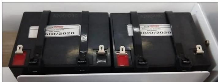
Encaixar os 04 conectores nos bornes das baterias, conforme tabela abaixo:
