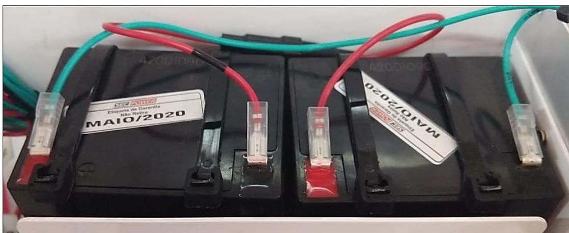
Deve-se desmontar o chicote elétrico das baterias:
